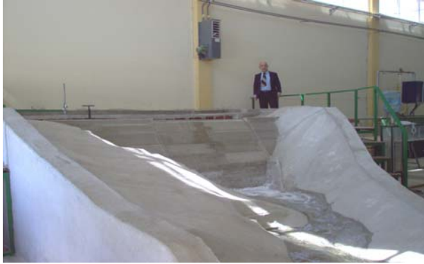
Şekil 3. Çine barajı basamaklı dolu savağının 1/100 ölçekli modeli
