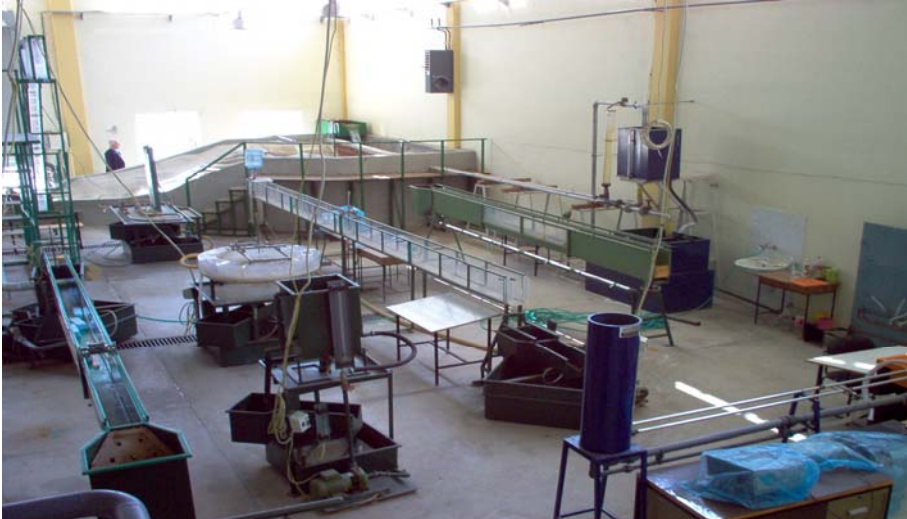
Şekil 1. Hidrolik Laboratuarında yer alan deney cihazları ve Çine barajı basamaklı dolu savağının 1/100 ölçekli modeli
