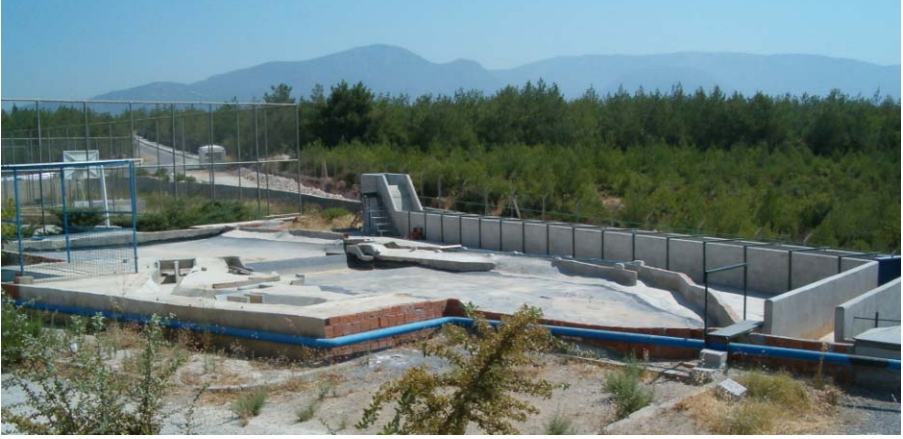
Şekil 5. DEÜ Hidrolik Laboratuvarı açık alanındaki 1/10 ölçekli Dehliz Regülatörü modeli ve 24 m uzunluklu açık kanal
